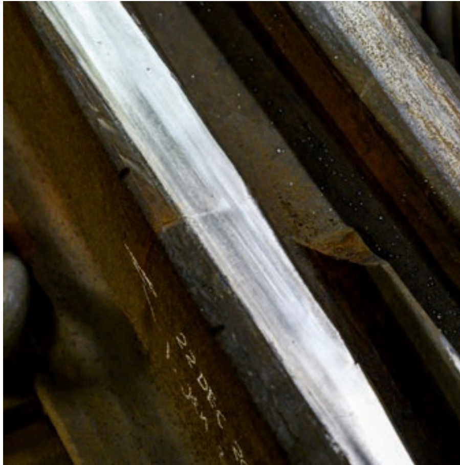
KRITISK: Utgangspunktet for nattens jobb er et nesten gjennomgående skinnibrudd i den mest kritiske delen av et sporkryss i Oslotunnelen.
