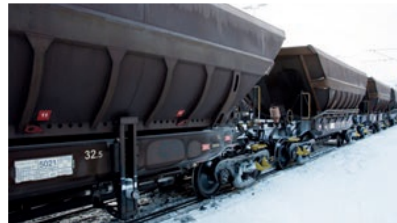
32,5 TONN: I februar ble det satt i gang prøvedrift med 32,5 tonns aksellast på Ofofbanen.
