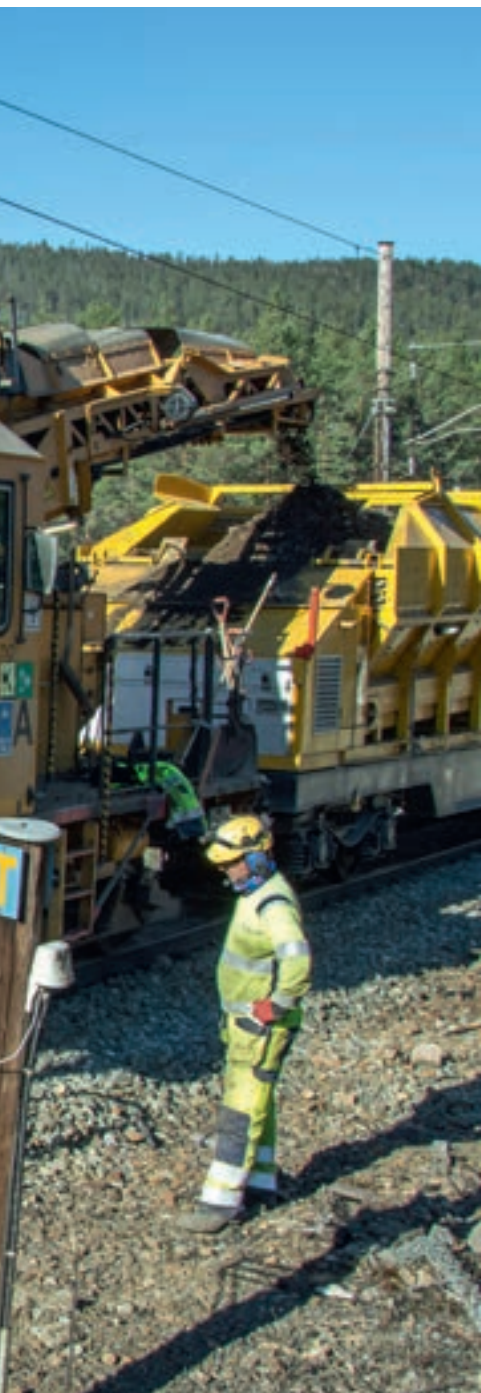
ARBEIDSHEST: Dette ballastrenseverket gjør jobben når sporet skal fornyes, gammel pukk fjernes og ny legges på.
