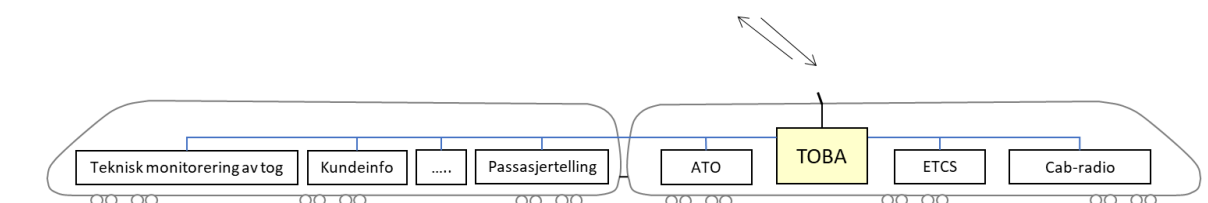
Figur 10 FRMCS ombordutrustning i tog
