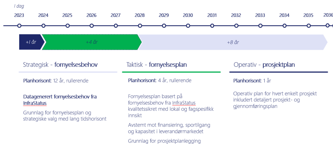
Figur 10 Fasene i fornyelsesplanleggingen i Bane NOR.
