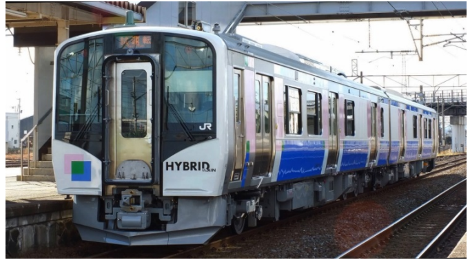
Figur 36: Japan Rail (JR) Freight's dieselhybrid benytter Li-ion-basert batteriteknologi (til venstre). Denne, samt JR-persontog også som dieselhybrid, ble satt i drift i 2010 og nytt materiell i 2015 (til høyre).
