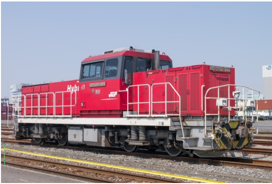
Figur 36: Japan Rail (JR) Freight's dieselhybrid benytter Li-ion-basert batteriteknologi (til venstre). Denne, samt JR-persontog også som dieselhybrid, ble satt i drift i 2010 og nytt materiell i 2015 (til høyre).
