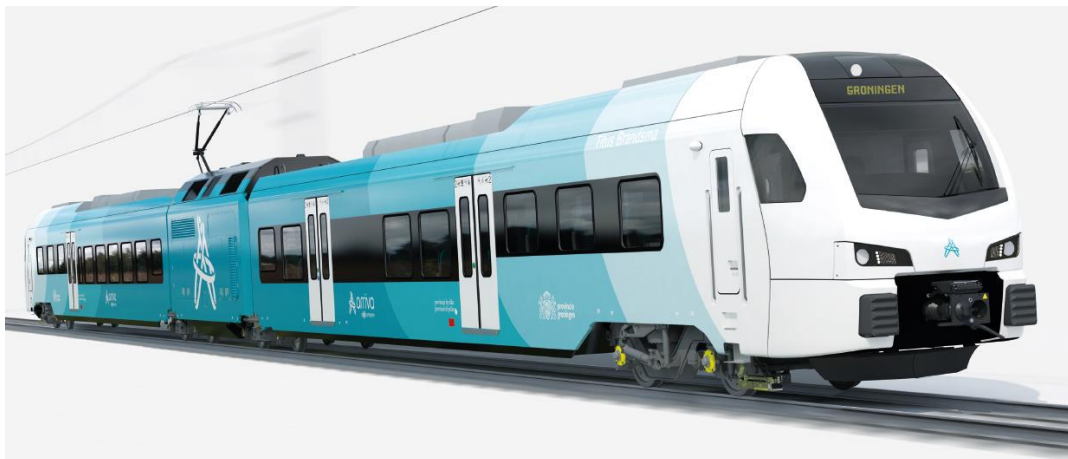
Figur 17: Stadler Wink batteritog med mellomvogn for batteriinstallasjon (36).
