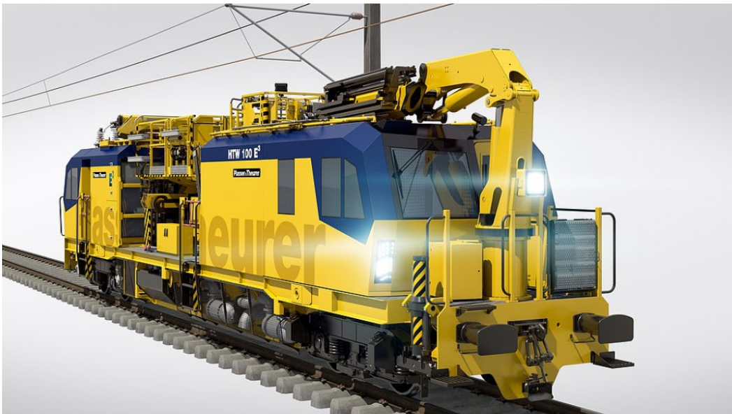
Figur 1: Ledningsmaskin Plasser&Theurer HTW 100 E 3 for arbeid med KL-anlegg (1).
