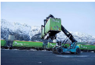
Figur 8 - vertikalt løft av trailer (kilde: Jernbanedirektoratet)
