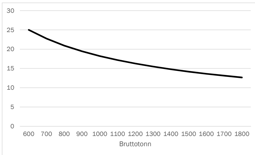
Figur 11 Energiforbruk per bruttotonnkilometer ved varierende bruttovekt. Wh/bruttotonnkilometer
