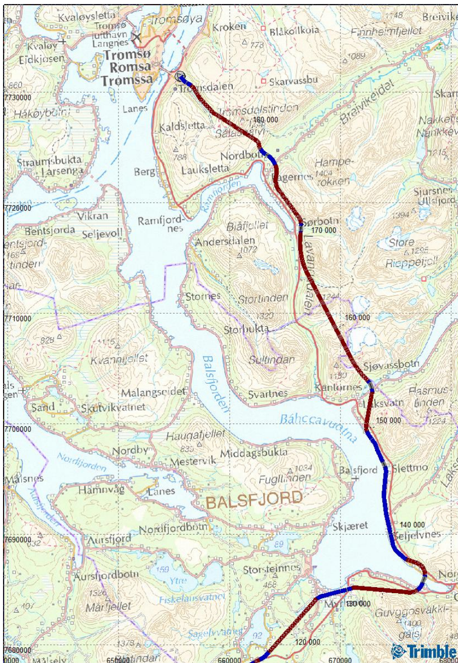
Figur 5-6 Innløpet til Tromsø. Nord for Balsfjorden. Utsnitt fra Quantm som viser hvor omtrent det blir dagsoner (blå), tunneler (rød) og bruer (grå).
