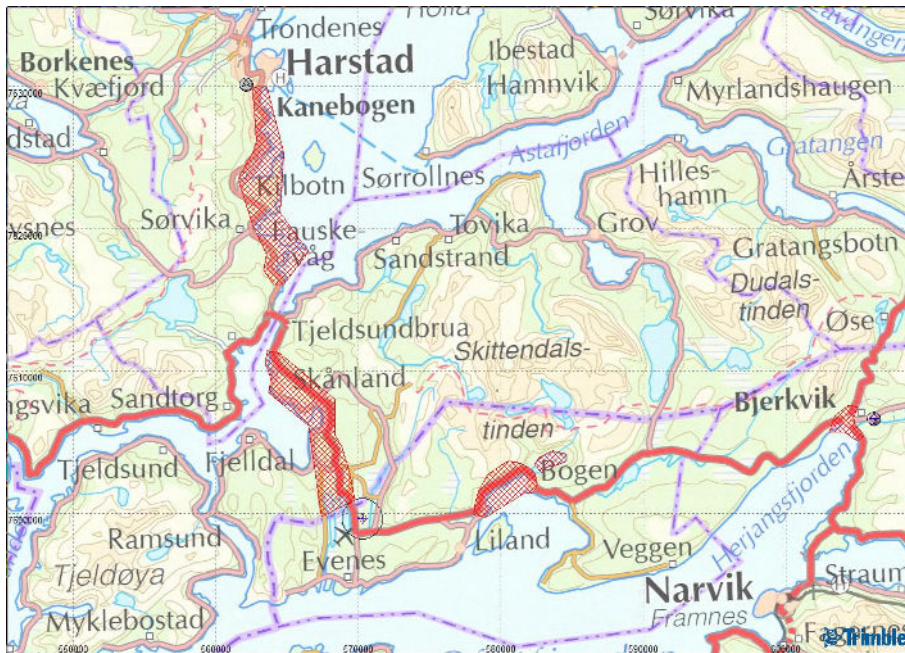
Figur 6-2 Bildet viser utgangspunktet for Quantm-søkene. Rødmærkede soner guider traséen utenom områder som ikke er ønsket, f.eks. eksisterende infrastruktur.
