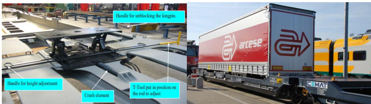
Figur 34 - T3000e dobbel pocketvogn med kingpinlås (Ferriere Cattaneo)
