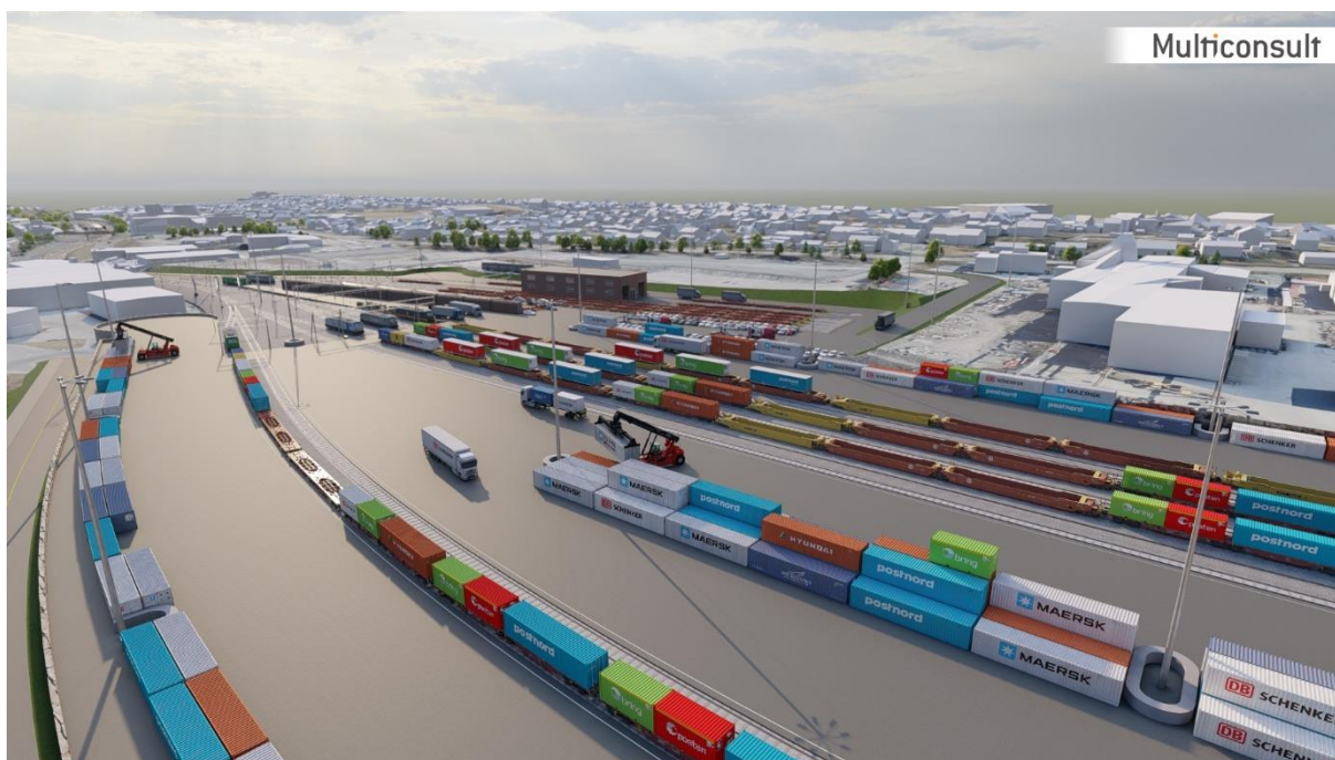
Figur 30 Biltrafikkavvikling med snuplass i enden over lastegater. Alternativ 2.
