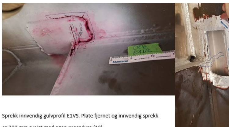
Figur 2 Innvendige sprekker under gulvet
