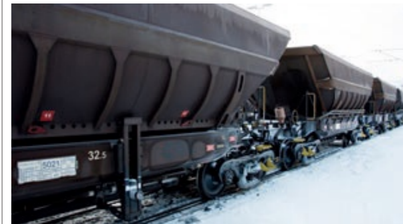
32,5 TONN: I februar ble det satt i gang prøvedrift med 32,5 tonn aksellast på Ofofbanen.
