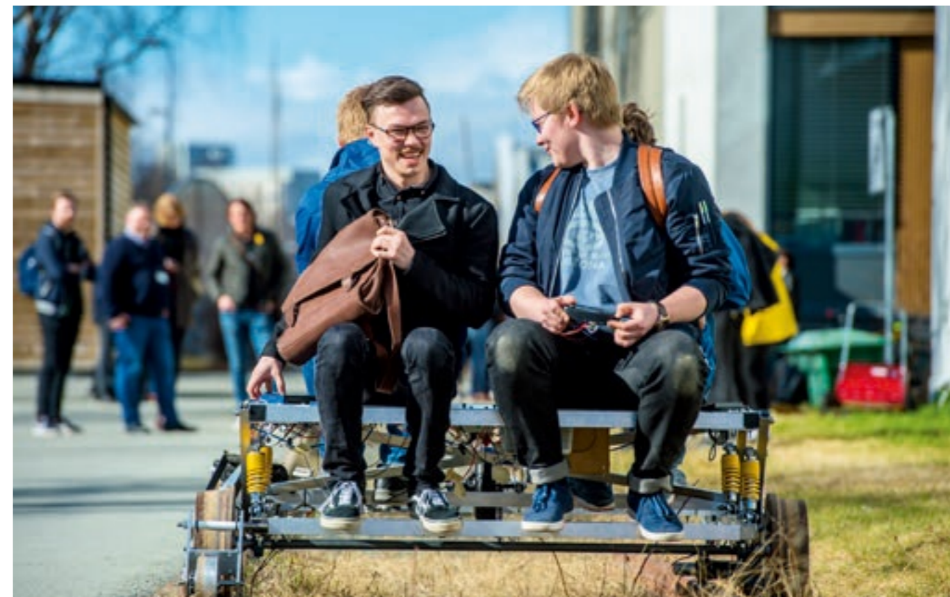
SELVBYGGET: NTNU-studentene Andreas Sæle (t.v.) og Kristoffer Venæs Monsen har sammen med flere studenter i «Eksperter i team» bygget en selvkjørende robottralle. Den kan måle friksjon og blant annet koste bort støv på skinnene.
