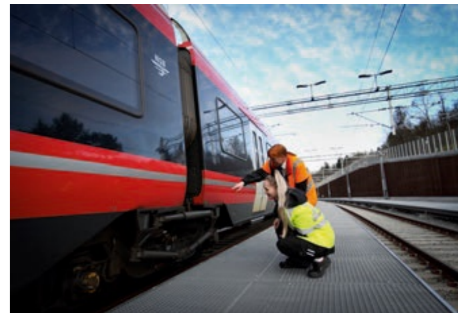
ALT I ORDEN: Utvendig visitasjon av togsettet foregår ved uttak og klargjøring av tog: – Vi sjekker at boggi og komponenter som kabler, bremsestell og hjul er i orden og ikke har skader.
