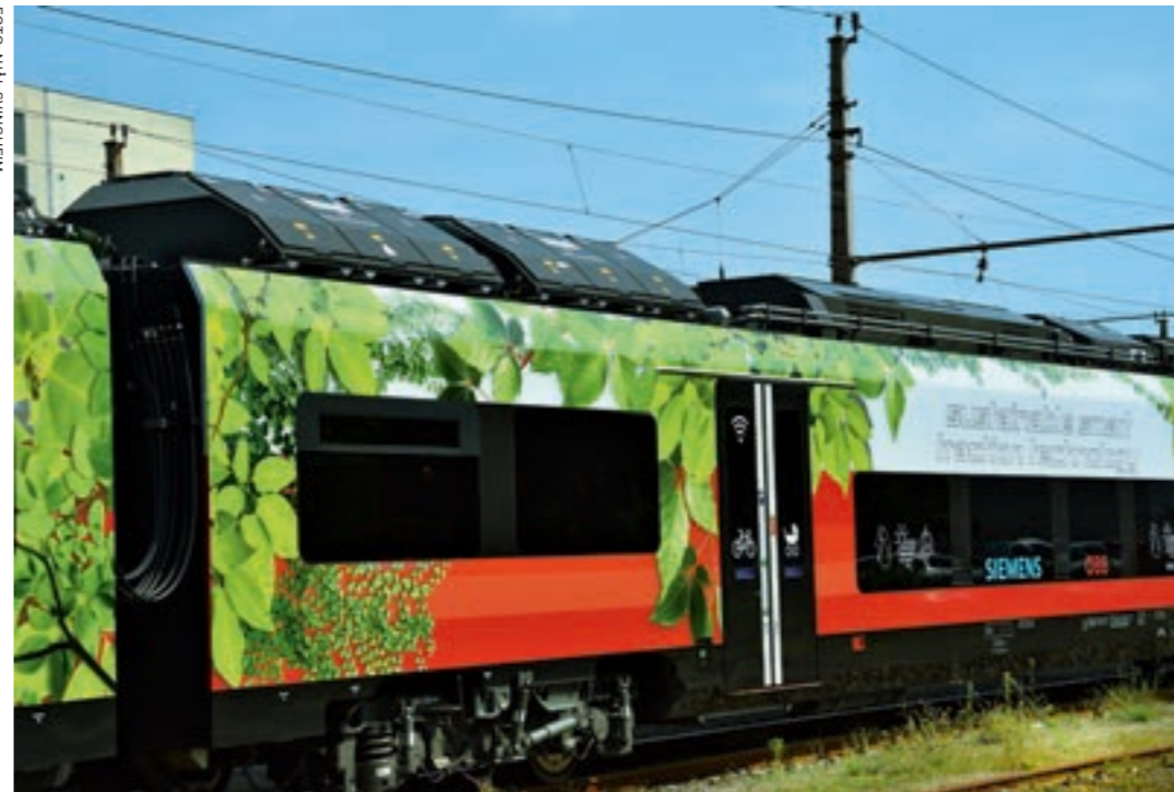
PÅ TAKET: Batteriene er montert på taket på Siemens sine tog.
