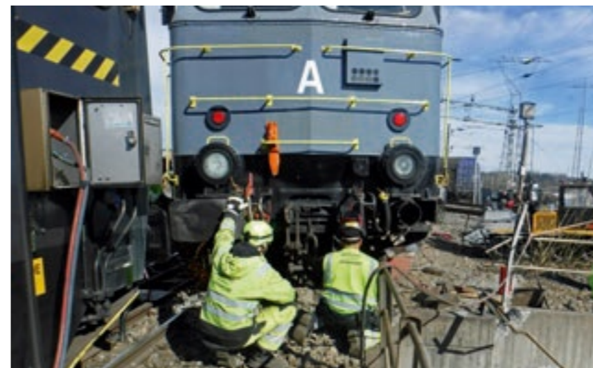
KRAFTIGE JEKKER: Her løftes den ene boggien i et avsporet MZ-lok tilbake sporet ved hjelp av hydrauliske jekker.
