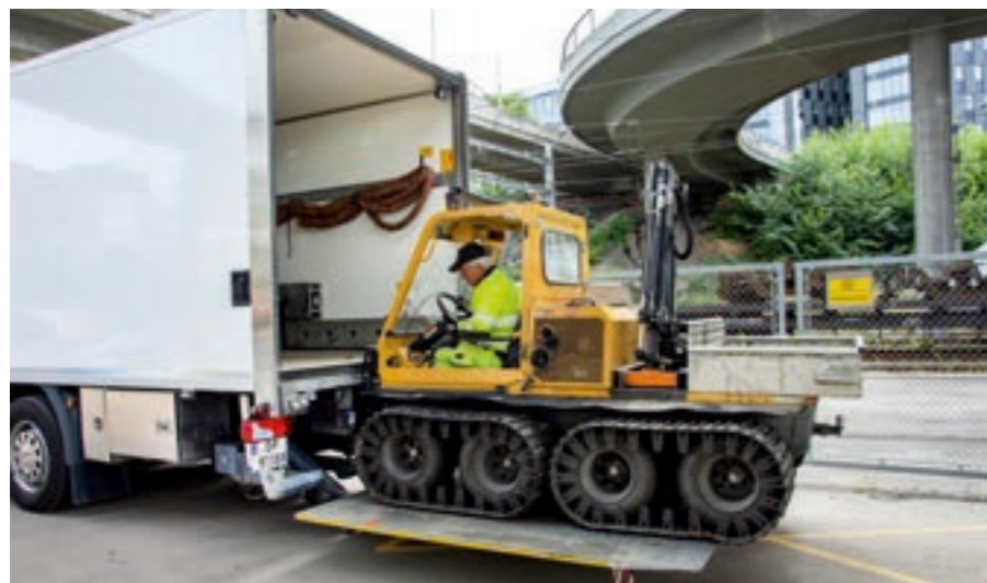
KJEKT Å HA: Med terrengkjøretøy kan bergingsutstyret fraktes inn på de mest utilgjengelige steder.
