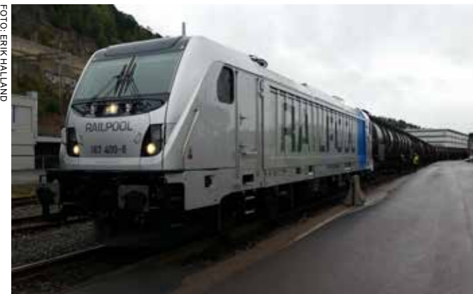
1400 TONN: Hybridloket trakk det 1400 tonn tunge drivstofftoget fra Sjursøya til Loenga uten problemer.
