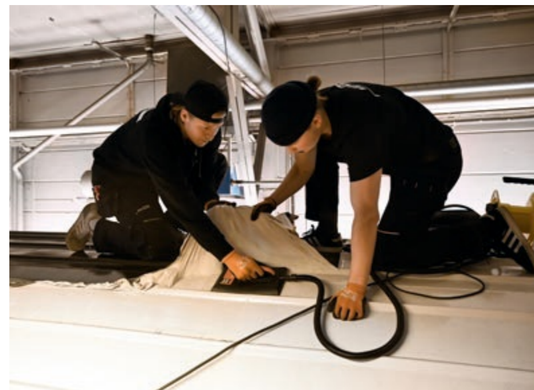
TILBAKE TIL ORIGINALEN: Julis Aven (til venstre) og Roni Hermonen river av folien og originalfargen trer fram. Legg merke til tapetfjerner/dampkokeren de bruker for å varme opp folien.
