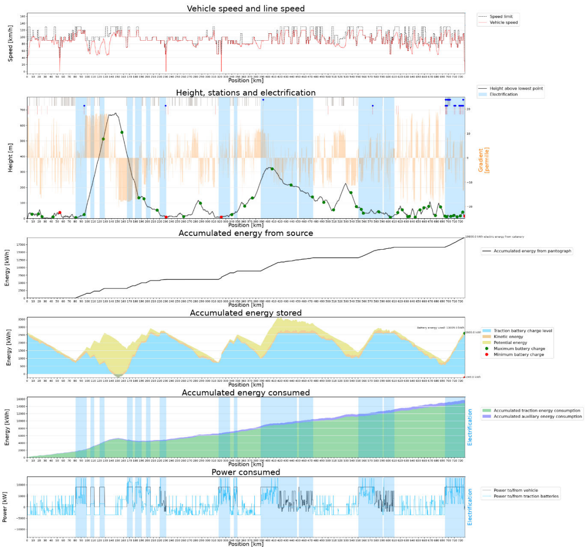
Figur 113: Simuleringsresultat for godstogslinje GK25a, Bodø-Trondheim. Redusert strømgrens til kjøretøyet fra 800 A til 600 A, som tilsvarer en reduksjon fra 12 MW til 9 MW.
