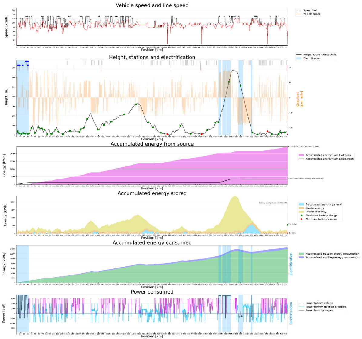
Figur 87: Simuleringsresultat for godstog GK25a, Trondheim – Bodø med konsept 2b, hydrogen med del-elektrifisering. Grå ruter i graf nr 2 viser tunneler, og røde strek viser overgangsbruere. Blå prikk betyr at tunnelen eller overgangsbroen er på elektrifisert strekning.
