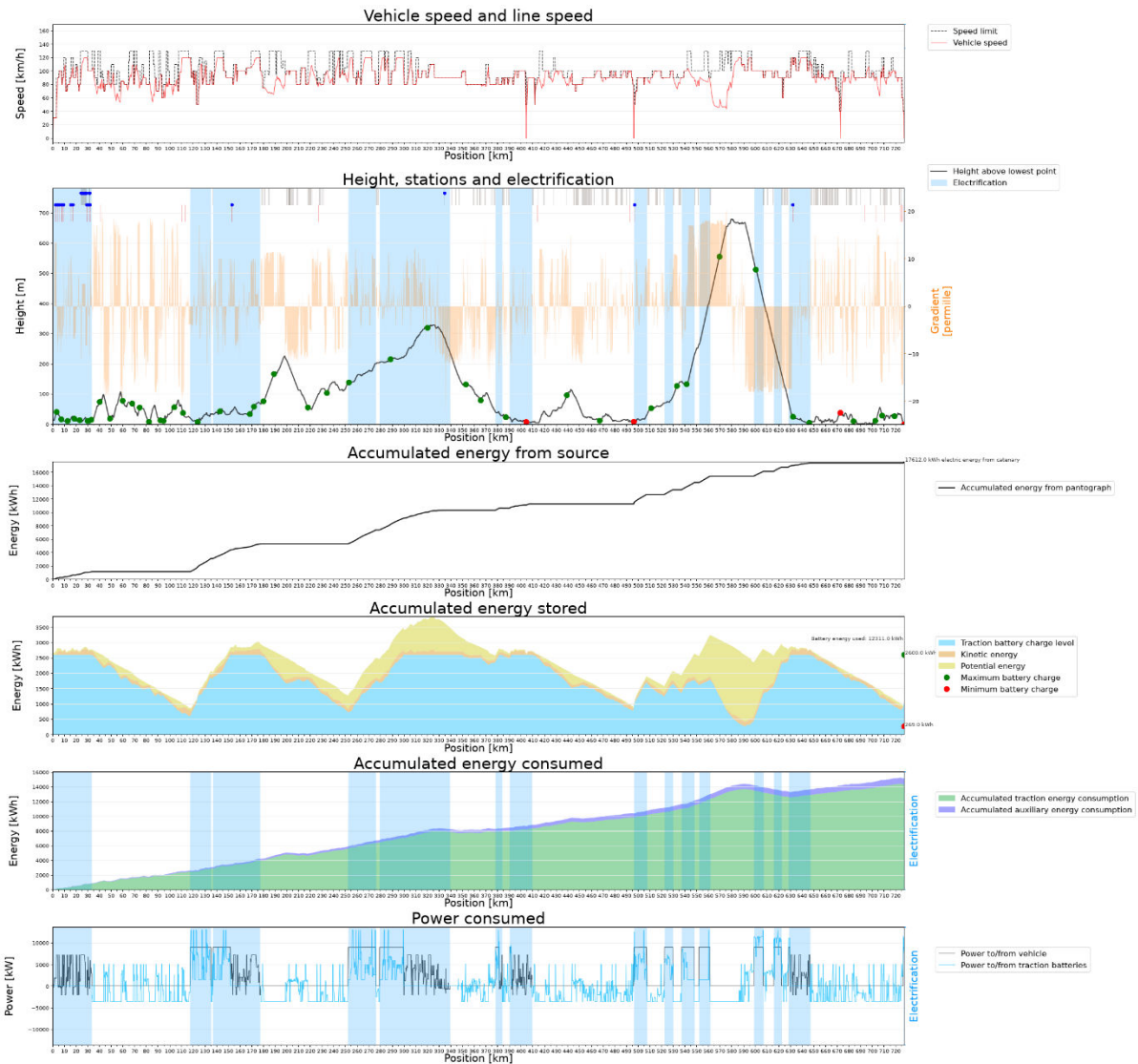
Figur 112: Simuleringsresultat for godstogslinje GK25a, Trondheim-Bodø. Redusert strømgrens til kjøretøyet fra 800 A til 600 A, som tilsvarer en reduksjon fra 12 MW til 9 MW.
