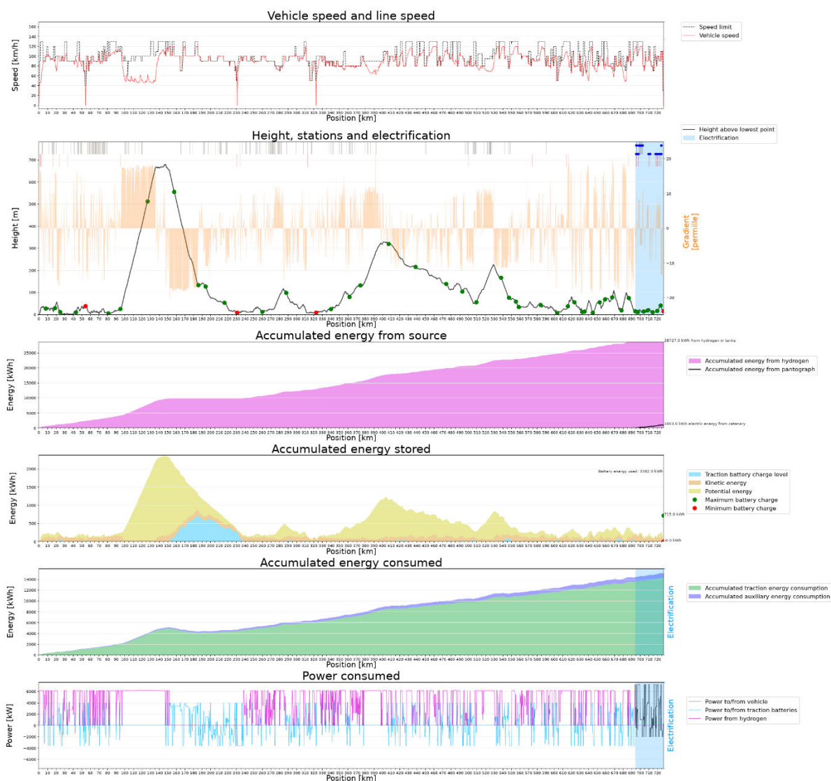
Figur 85: Simuleringsresultat for godstog GK25a, Bodø–Trondheim med konsept 2a, hydrogen. Grå ruter i graf nr 2 viser tunneler, og røde strek viser overgangsbruer. Blå prikk betyr at tunnelen eller overgangsbroen er på elektrifisert strekning.
