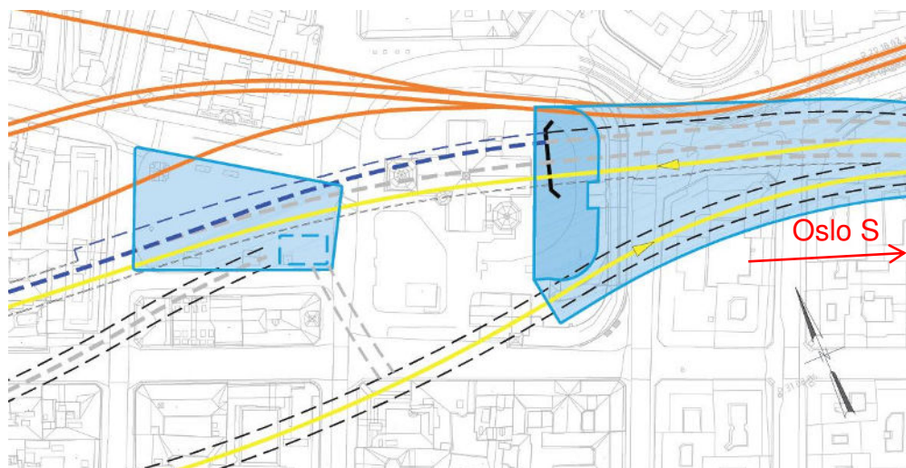
Figur 24: Fase 2, bygging av ny tunnel for utgående tog
