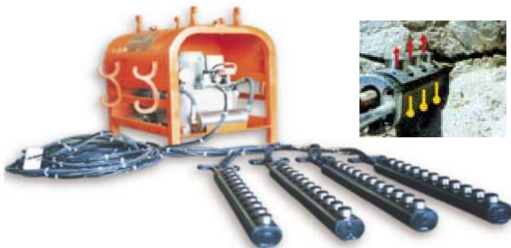
Figur 23: Hydraulisk bergbryter utstyr; sylinder med tverrstempel som presses ut inne i borhullet
