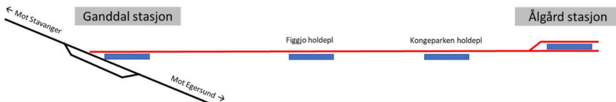
Figur 5-3: Forenklet skjematisk sporplan for alternativ 1A
