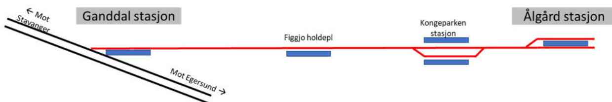
Figur 5-11: Forenklet skjematisk sporplan for alternativ 3A
