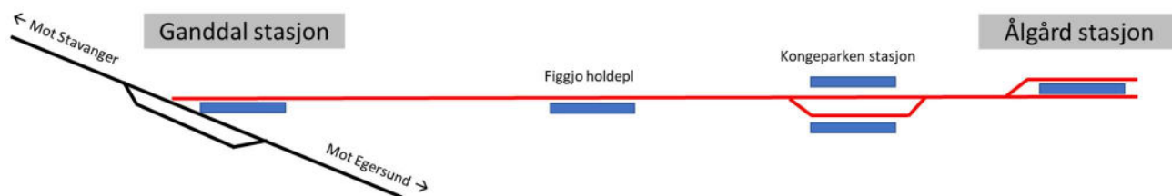
Figur 5-5: Forenklet skjematisk sporplan for alternativ 1B
