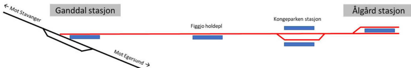
Figur 5-7: Forenklet skjematisk sporplan for alternativ 2A
