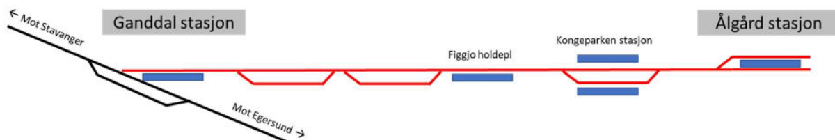
Figur 5-9: Forenklet skjematisk sporplan for alternativ 2B
