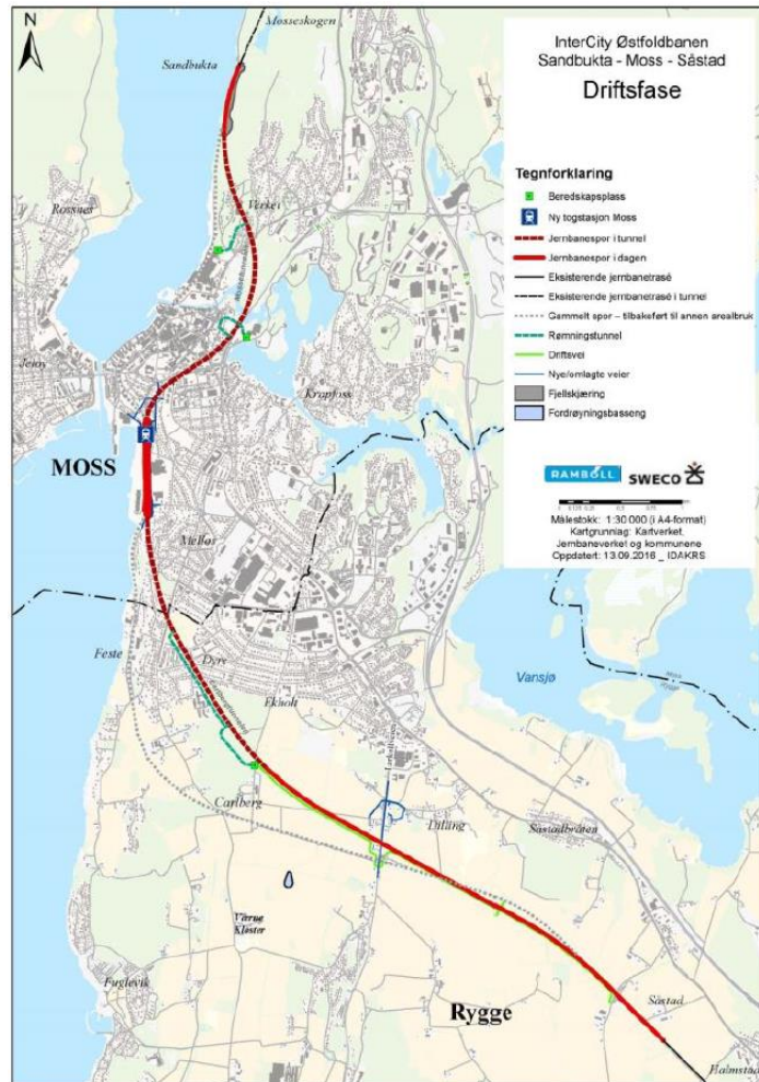
Figur 10-2 Ny trasé Sandbukta–Moss–Sæstad i rødt. Grå, stiplet linje indikerer dagens trasé. Kilde: Bane NOR
