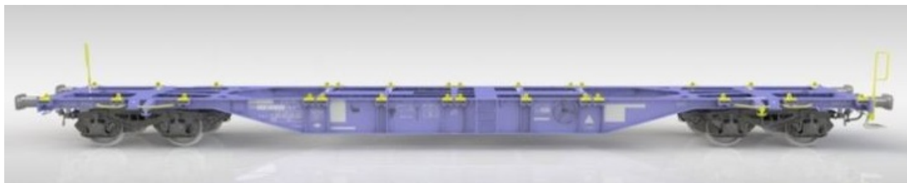
Figur 37: Sgnss-boggivogn (Greenbrier Europe [148]), som antas standardplattform for batterier og hydrogen.
