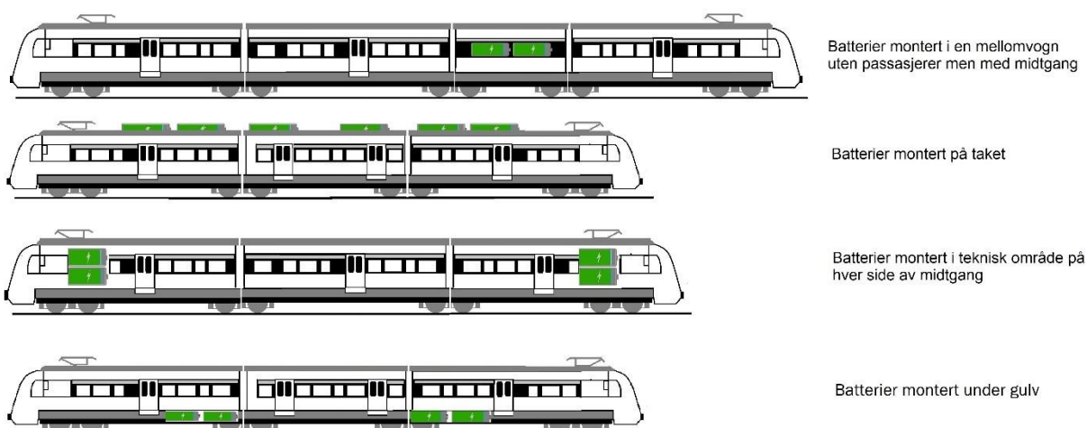
Figur 8: Illustrasjon av mulige løsninger for BEMU, der utstyr montert på taket er en vanlig løsning bland de produkter som tilbys på markedet pr. 2021.
