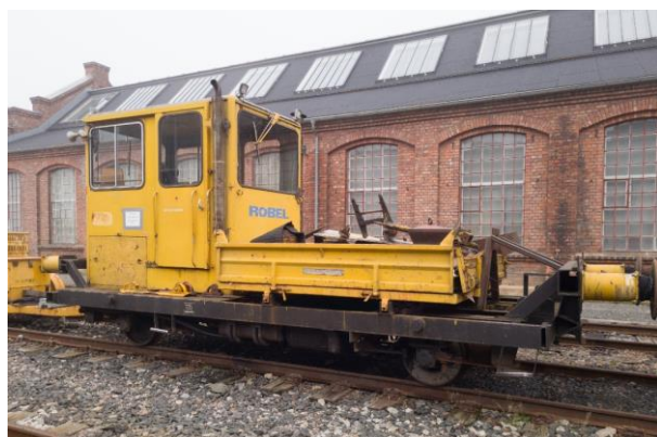
Tøffe (Robel 54.12) ble gitt til museet av Mantena, og ble produsert i 1975 av Robel & co. En lastetraktor, ofte kalt Robel, er en internmaskin for transport av redskap og materiell. Foto: Ida Marie Munkerud (NJM) / JM008956
