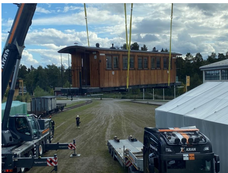
Vognkassen til Co9 løftes over på Robel-traller foran verkstedet på Martodden. Foto: Vasco T. Duarte (NJM)
