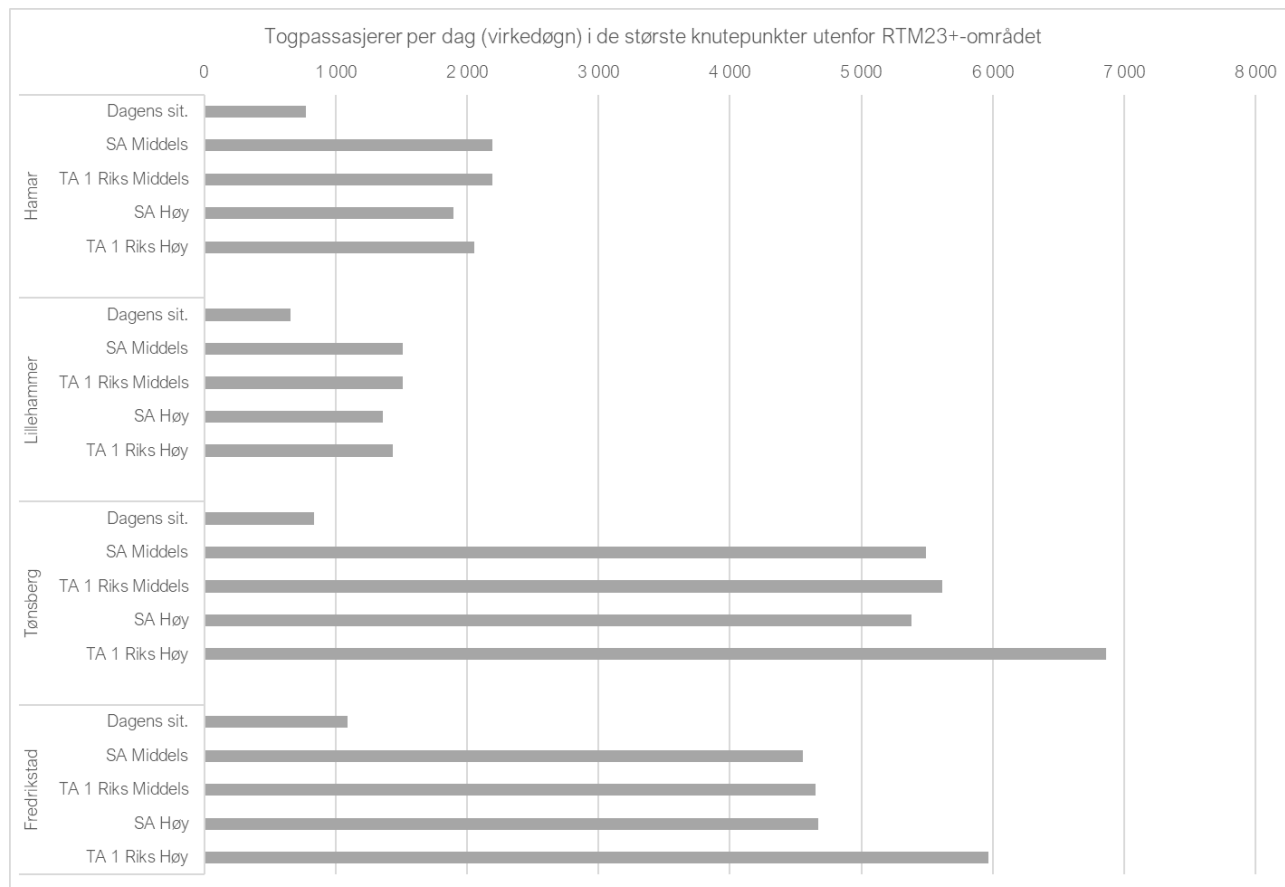
Figur 4-18. Antall togpassasjerer per dag (virkedøgn) ved de største knutepunktene utenfor RTM23+ i både sammenligningsalternativet og tiltaksalternativ 1 Riks, med middels og høy innsats.
