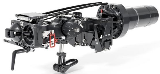
Figur 3-1. Digital Automatisk Kobling for godslokomotiv og -vogner. Foto: Voith(2024)
