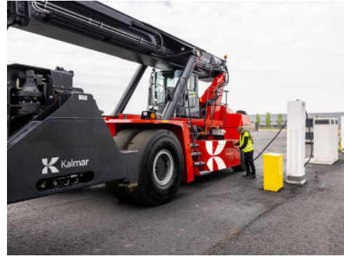
Figur 3-15. Elektrisk reach stacker som lader. Kilde: Kalmar (2025)
