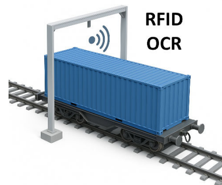
Figur 3-9. Automatisk avlesning av lastbærer-ID ved bruk av RFID, OCR etc. Illustrasjon: KI-generert
