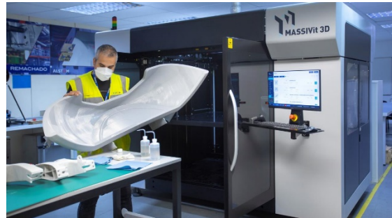
Figur 3-10. 3D-printing av komponenter til jernbane. Kilde: Alstom(2023)
