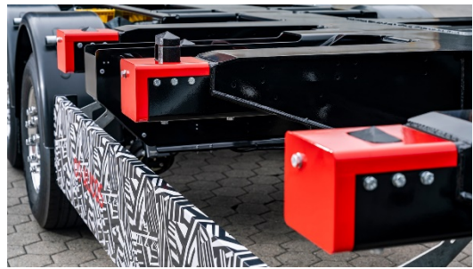
Figur 3-8. Teknologi for automatisk pinposisjonering på lastebilchassis kan også overføres til jernbanevogner. Kilde: Krone(2025)
