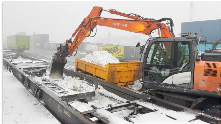
Figur 3-7. Fjerning av snø og is fra godsvogn for semitraller. Foto: Sam Pawar
