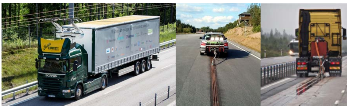
Figur 23. Eksempel på tre ulike løsninger for dynamisk konduktiv energioverføring til kjøretøy i bevegelse, a) Systems fra Siemens eHighways med to overhengende kjøreledninger [Siemens e-Highway, 2017], b) konsept fra Elways i Sverige basert på skinne med nedsenkede ledere i veibanen [Olsson, 2014] c) konsept fra Alstom, med seksjonerte strømskinner på veioverflaten [Teknisk Ukeblad, 2013]
